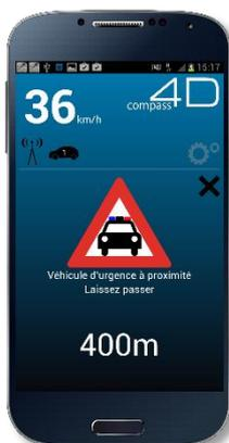
Lorsqu'un véhicule du SDI33 équipé de COMPASS4D est en approche et en intervention, il envoie un signal d'alerte que les véhicules vont recevoir. Un message d'alerte apparaît alors sur l'application Smartphone et un signal sonore retentit. L'alerte est aussi donnée lorsqu'un véhicule de travaux publics est en approche. Ces véhicules diffusent leur position et leur état de manière continue via leur UEV (unités à bord des véhicules).
